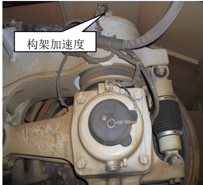
图 4 转向架传感器安装示意图
