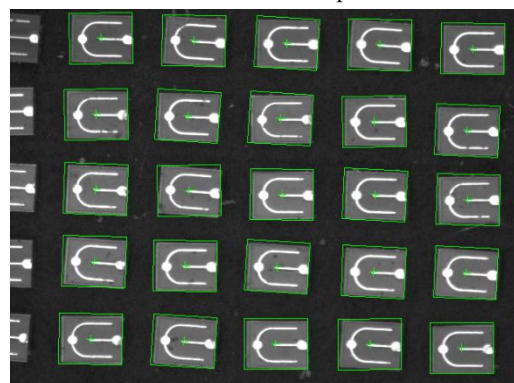
图 17 采用几何模板匹配的方法得到的芯片中心
