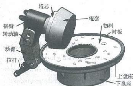
图1 立磨运动部件的简化模型 Fig.1 Simplified Model of VRM Parts
