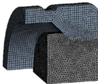
图10 阀芯有限元分析模型
